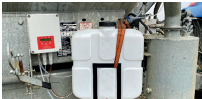
Sodobno doziranje sredstva N-Lock™ SUPER v cisterno
